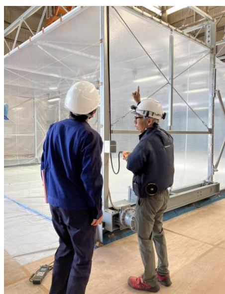
サドル用操作スイッチの使用方法及び伸縮後のリミットスイッチ機能説明
