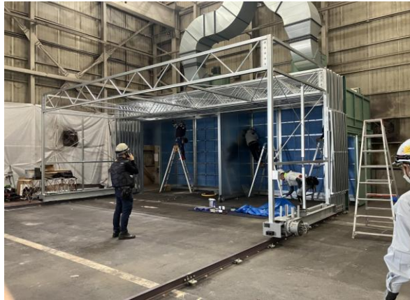
塗装エリアの伸縮式ブースの稼働チェック（最短）
