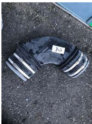
ゴム製エルボ 異常なし
