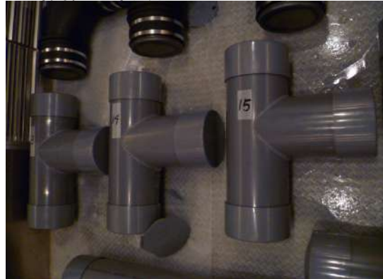
塩ビ加工品チーズが破損
