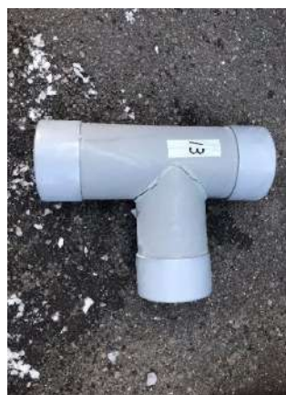
塩ビ加工品チーズ 溶接部割れ
