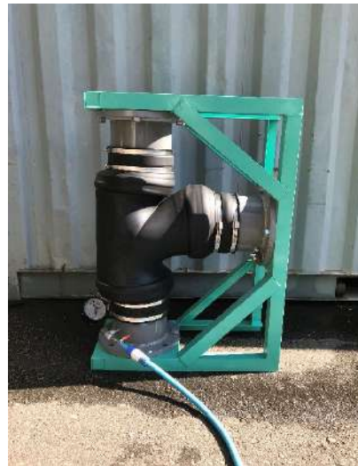
0.09MPa圧力負荷状況 試験結果・・・漏水、抜け等なし
