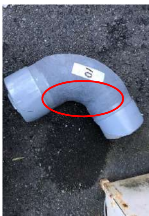
塩ビ加工品エルボ (FRP補強あり) ○部割れ
