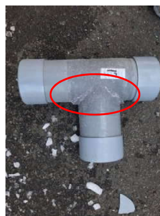
塩ビ加工品チーズ (FRP補強あり) 溶接部割れ
