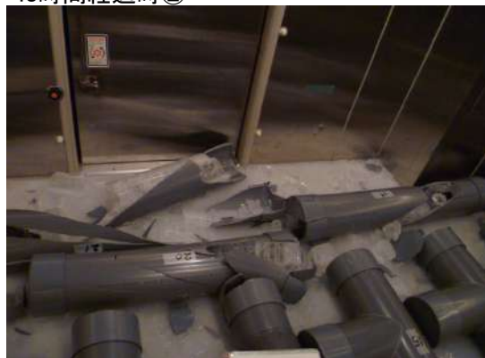
塩ビ加工品チーズが破損
